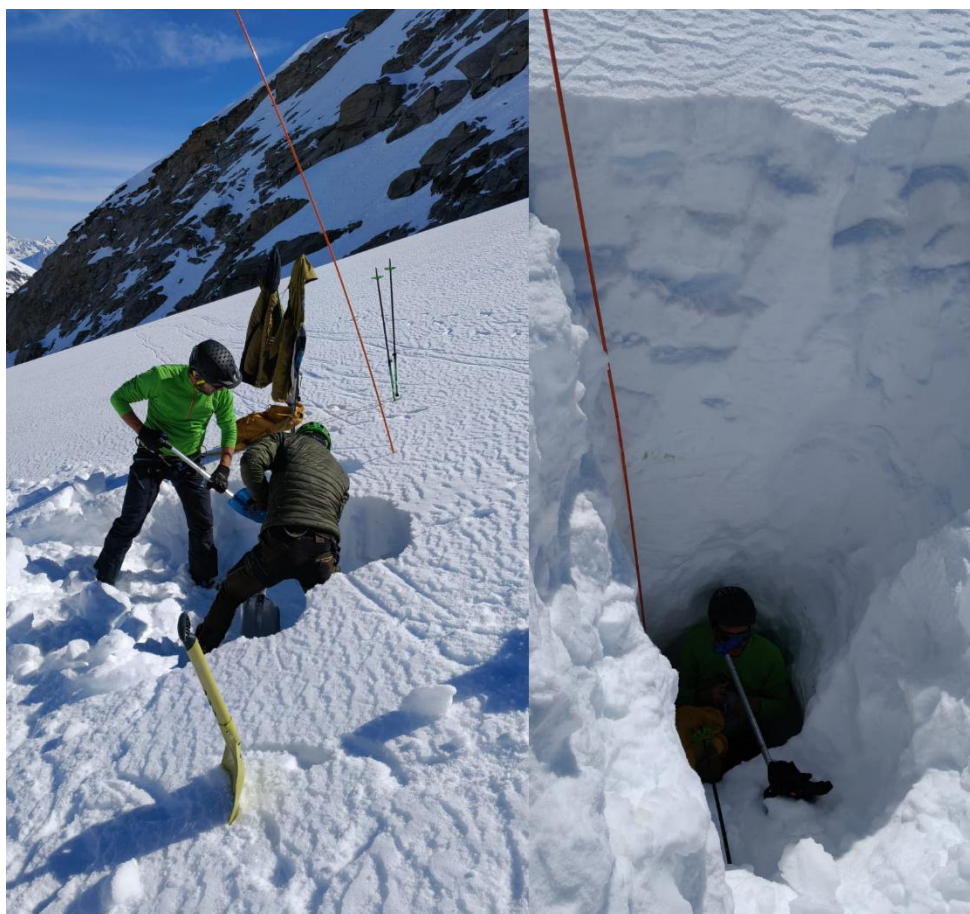
Figura 3 Trincea nivologica per il campionamento degli strati del manto necessari per la determinazione della densità media dell'intero manto nevoso al termine del periodo di accumulo maggio 2025 (ghiacciaio del Timorion).
