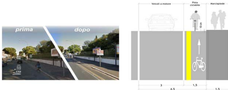
Figura 69 Pista ciclabile su corsia riservata su carreggiata
