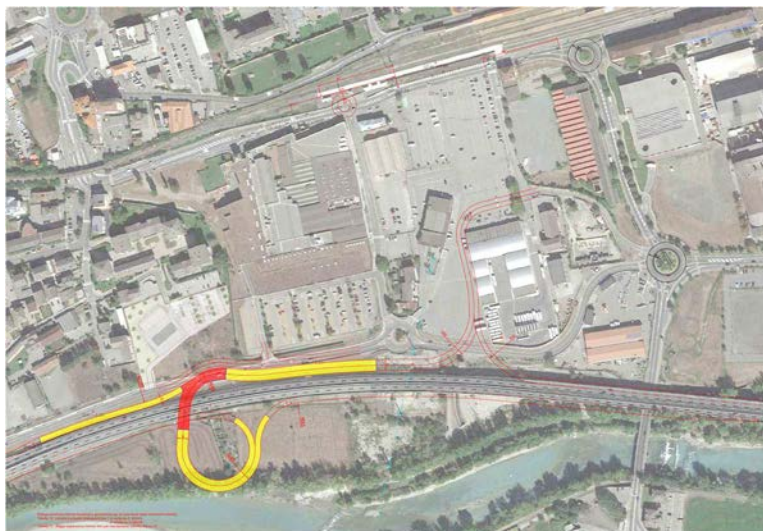
Figura 21 Schema funzionale esemplificativo alternativo della connessione autostradale [V1008] del Centro di Mobilità "Hub di Aosta" [T1004]
